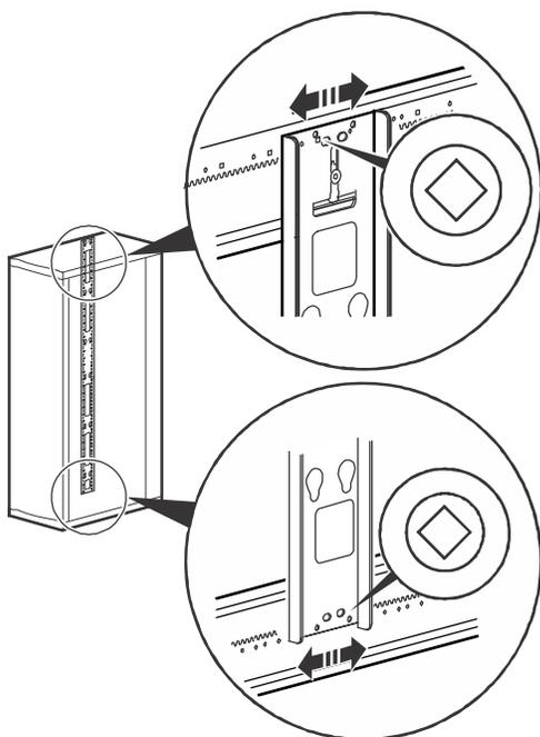
1. Levante y coloque el canal de cables trasero en los soportes laterales del armario. Asegúrese de que los tres ganchos de la parte posterior del canal de cables encajen en los soportes laterales del armario.
